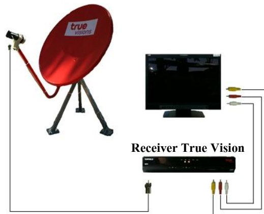
แผนผังการต่ออุปกรณ์เพื่อ TEST หาคุณภาพ
